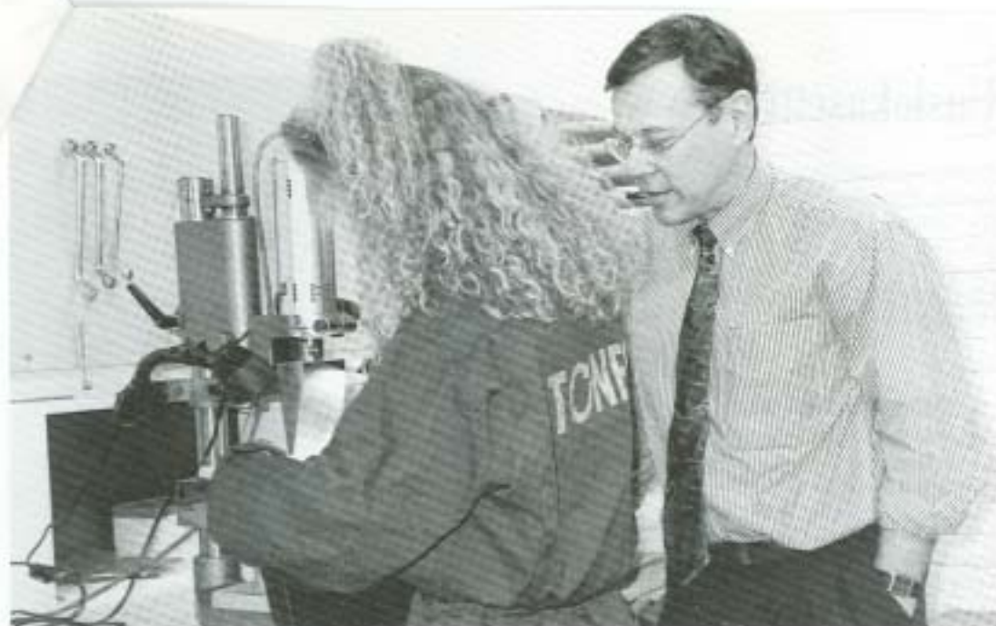
Riikka Salo hitsaa ultraäänilaitteella kirjoittimen värinauhaa yhtenäiseksi. Jukka Arkkilan mukaan kalliit kirjoittimien värinauhut kannattaa ehdottomasti uusia.
